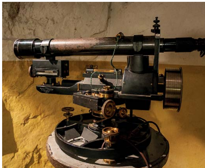
Lodbasmätare. Användes för att mäta in målen.
