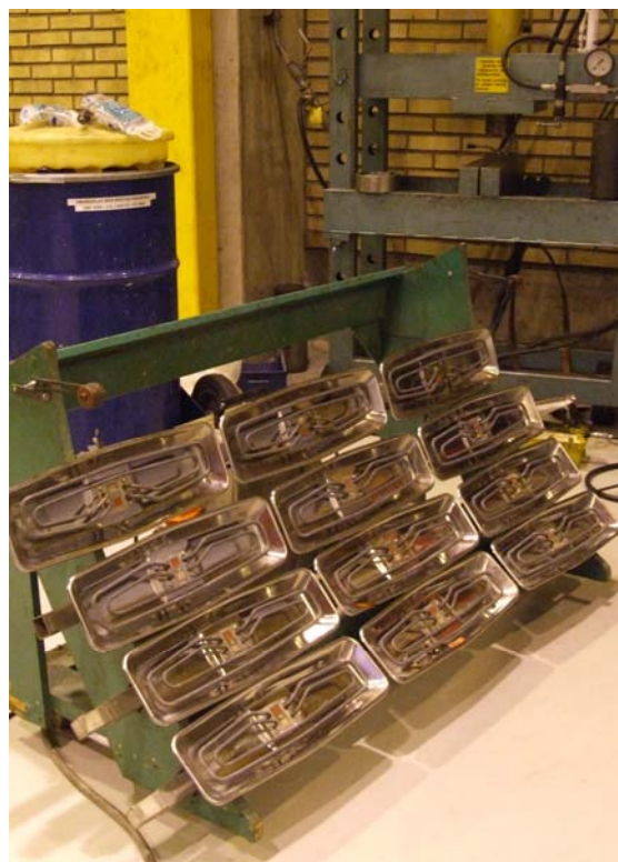
Utrustning för påkrympning av vira på formeringsvalsarna
