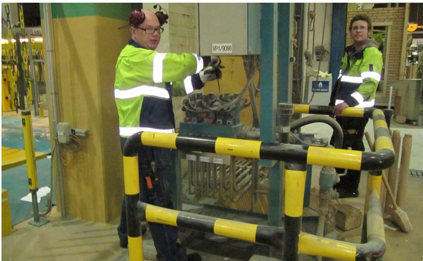
Lars "Ruckis" Jansson och Johan Klingholm förbereder byte av (hydraulik-)slangar till rullpuffare vid RM 11:1
