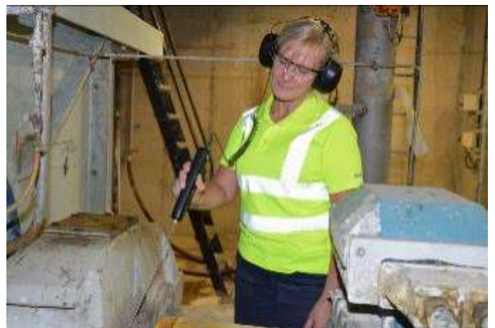
FU inspektör Madeleine Drakman lyssnar med hjälp av stetoskop på hur lager låter.
