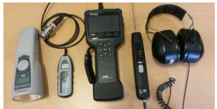
Instrument som en FU-inspektör använder: fr.v. Stroboscope - mäter man varvtal med, termometer, handinstrument för vibration och stötpulsmätning, samt stetoskop att lyssna på lager med.
