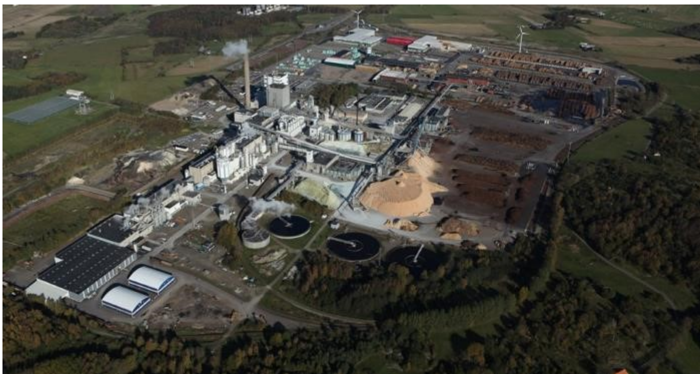
Utifrån veden som råvara producerar Södra Cell Värö högkvalitativ pappersmassa, grön el, fjärrvärme och biobränsle. I den utbyggda fabriken, med driftstart 2016, produceras 700 000 ton pappersmassa och 1,6 TWh energi per år.
