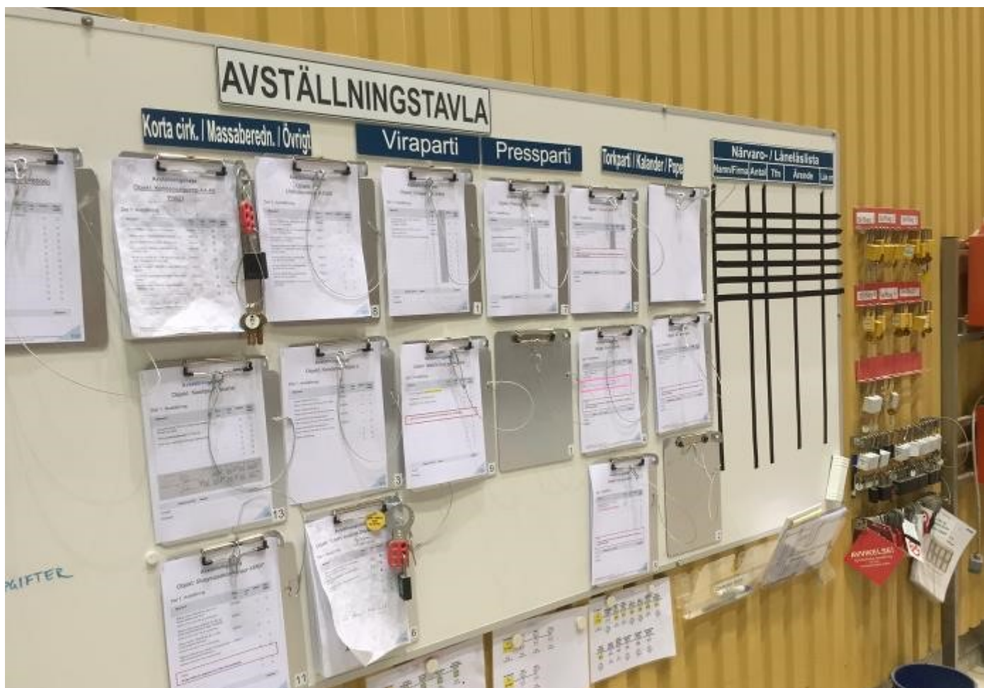
Avställningstavlan med avställningslistor och lås.
