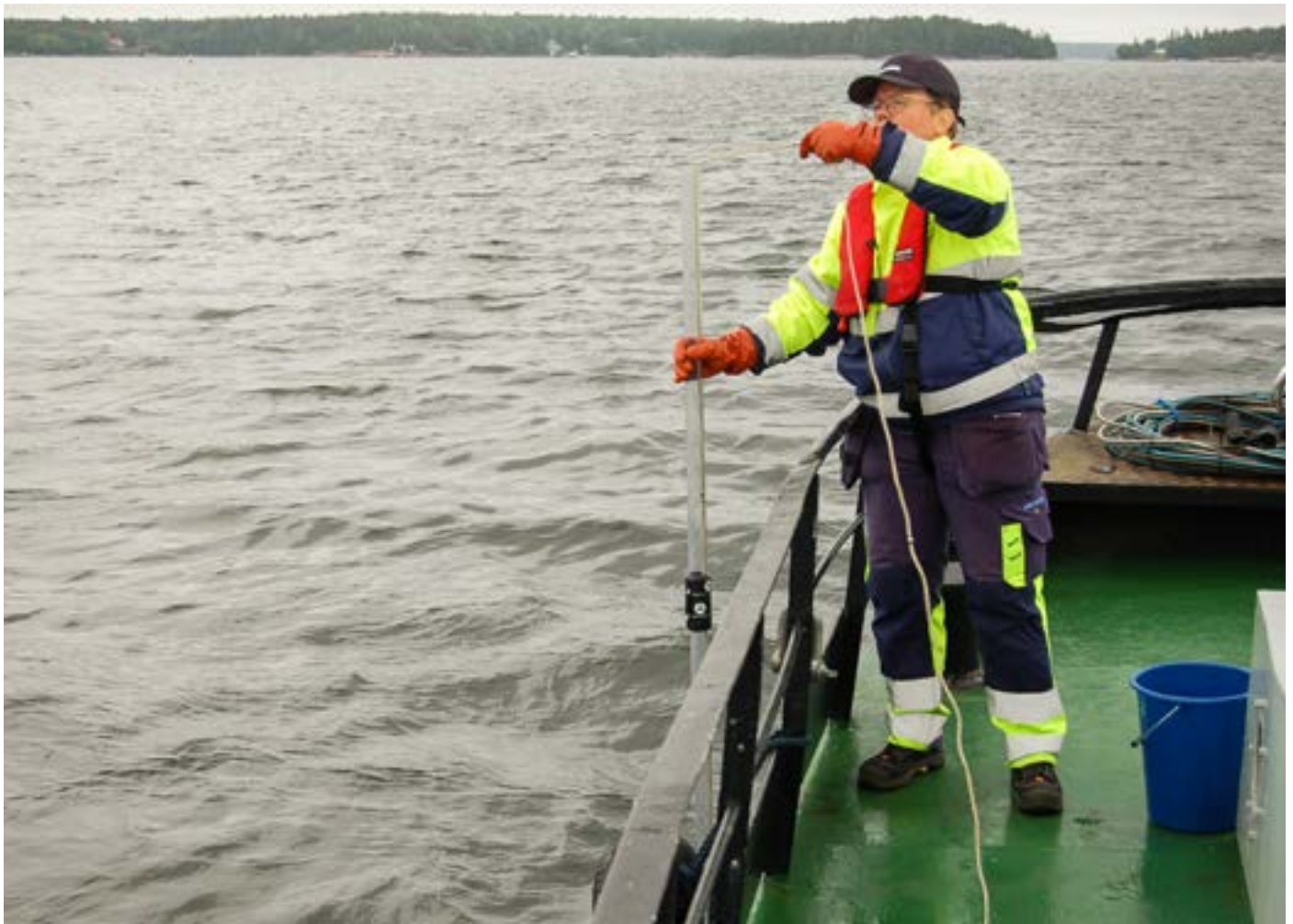
Prov på Epilimnion tas av Caroline med hjälp av ett Rambergör. Röret som är 2 meter långt sänks ner till avsett djup och samlar in provet. Epilimnion är vattnet från ytan ner till språngskiktet. På vintern när det inte finns något skikt tas ett profilprov från ytan ner till 6-10 meters djup, beroende på vattendjup.
