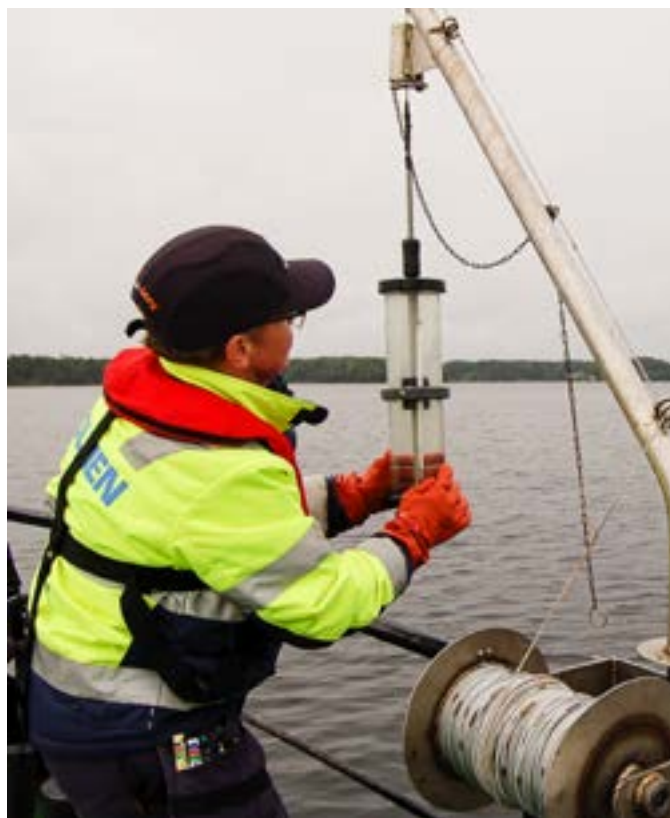
Caroline Rådberg läser av temperaturen från ett vattenprov som har hämtats upp med en ”Ruttnerhämtare”. Efter temperaturavläsningen så hälls provet upp i provtagningsflaskor.
