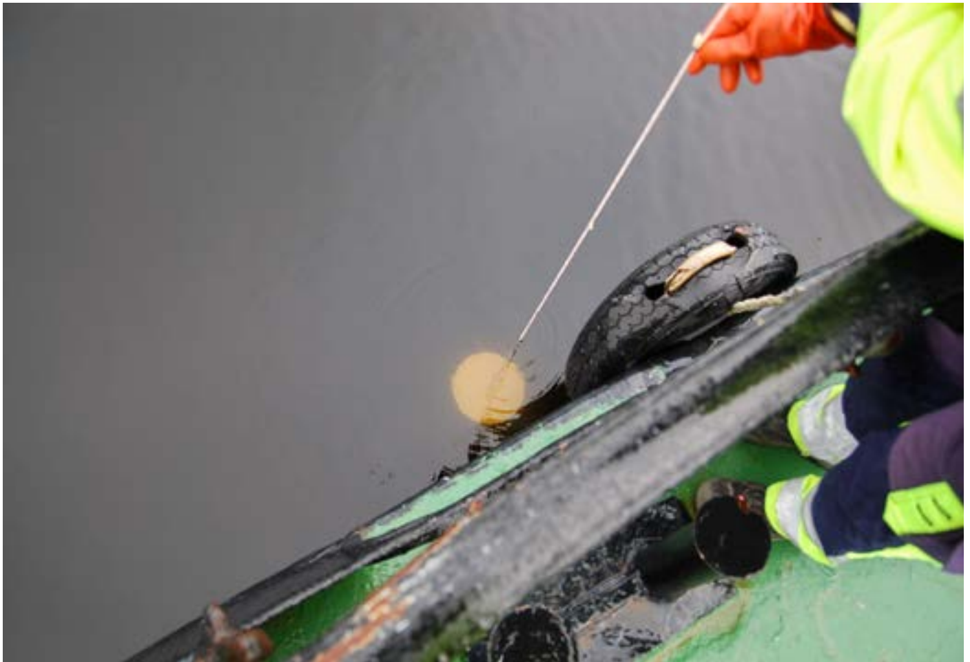
För att se siktdjupet så sänks en vit siktskiva ner i vattnet, En enkel men väl fungerande metod. På linan sitter det markeringar så man ser djupet där man inte ser siktskivan längre.
