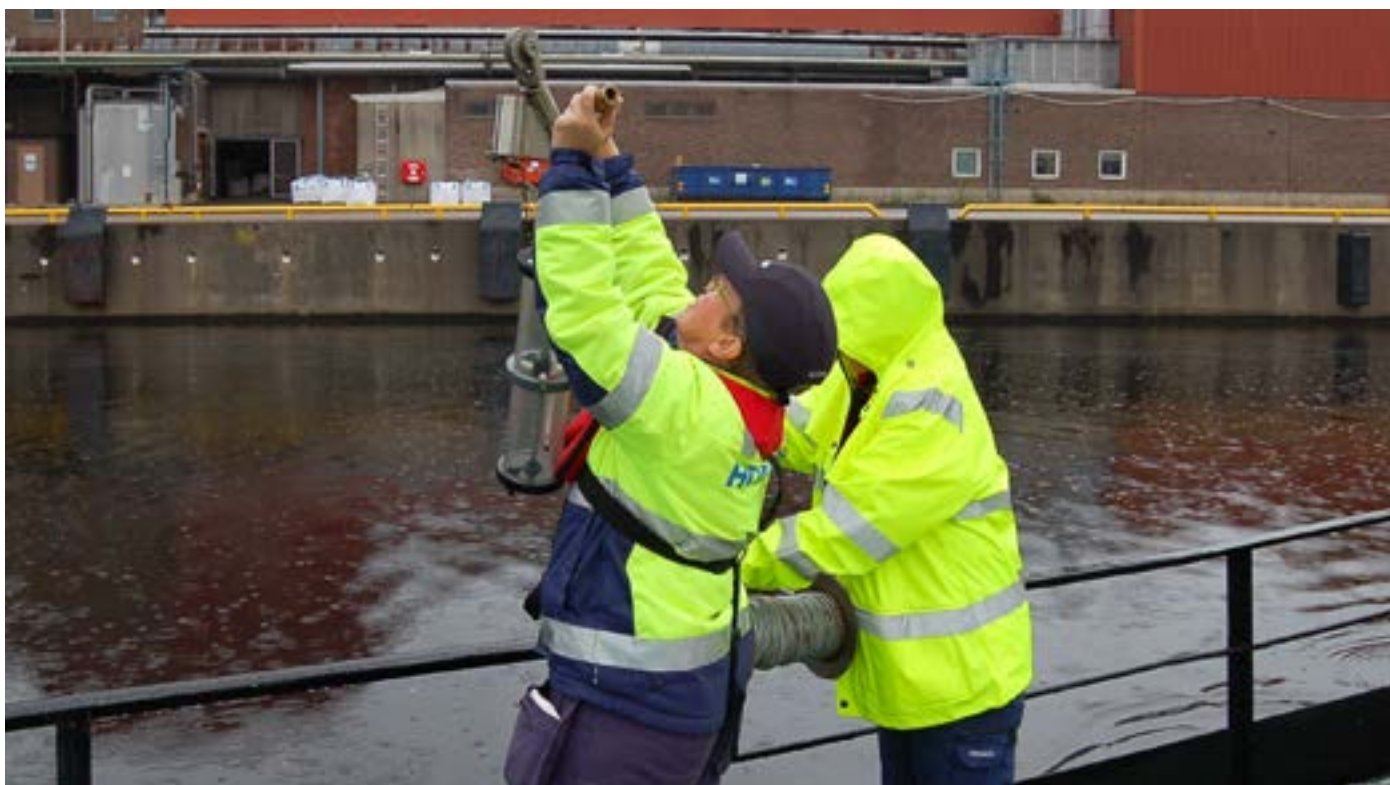
Caroline Rådberg läser av temperaturen från ett vattenprov som har hämtats upp med en ”Ruttnerhämtare”. Efter temperaturavläsningen så hälls provet upp i provtagningsflaskor.
