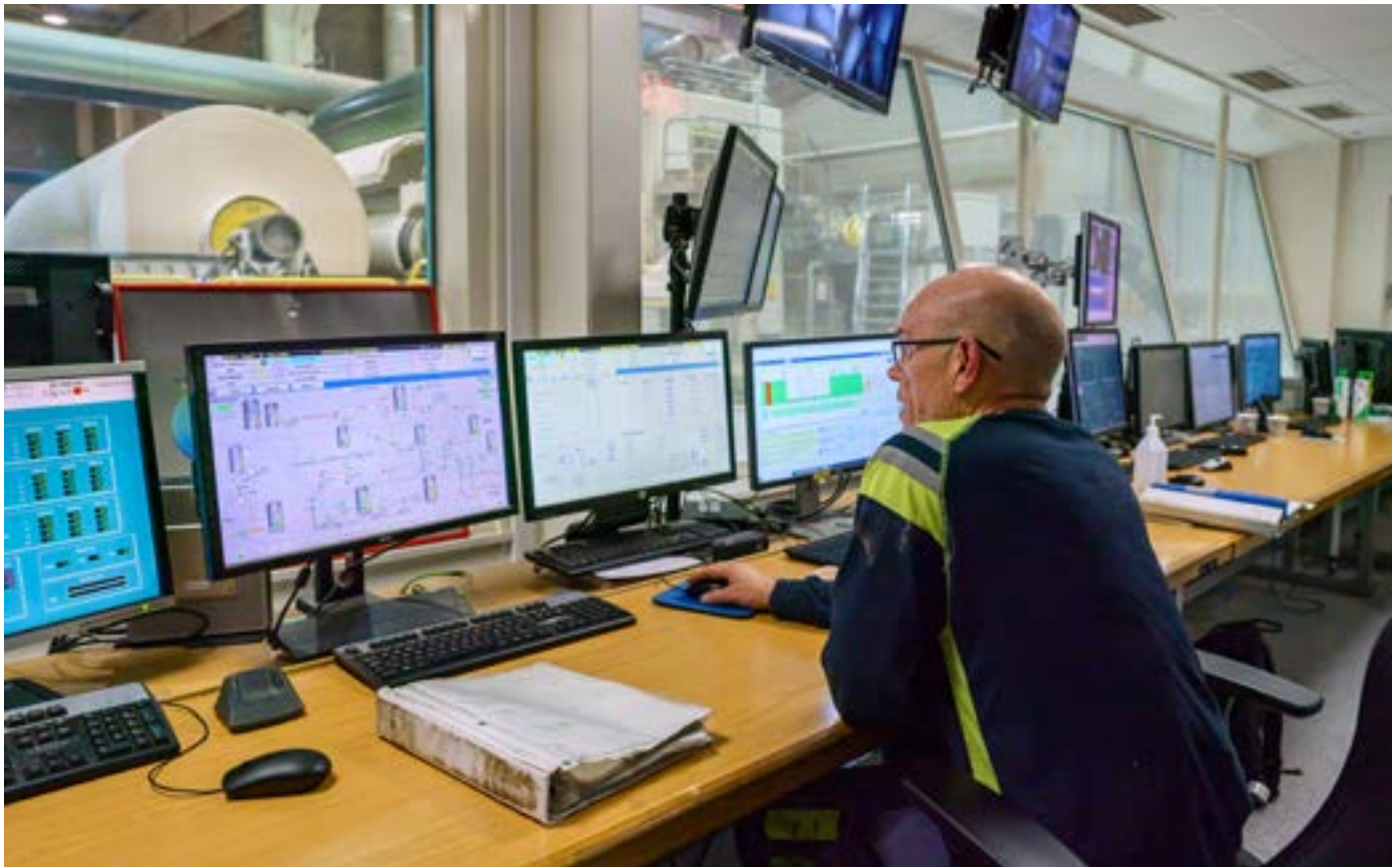
Benny Olsson håller koll på processen via skärmarna med information om hastigheter, tryck, nivåer, papperskvalitet och allt man kan tänkas behöva veta för att tillverka papper.
