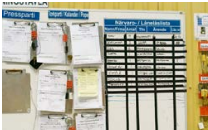
Avställningstavlan med bryt och lås. Alla externa måste registrera sig på tavlan med sina kontaktuppgifter.
