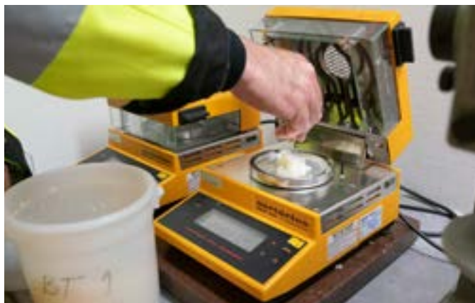
En del av massan vägs och torkas vilket ger parametrar till uträkningen av rest-VP.
