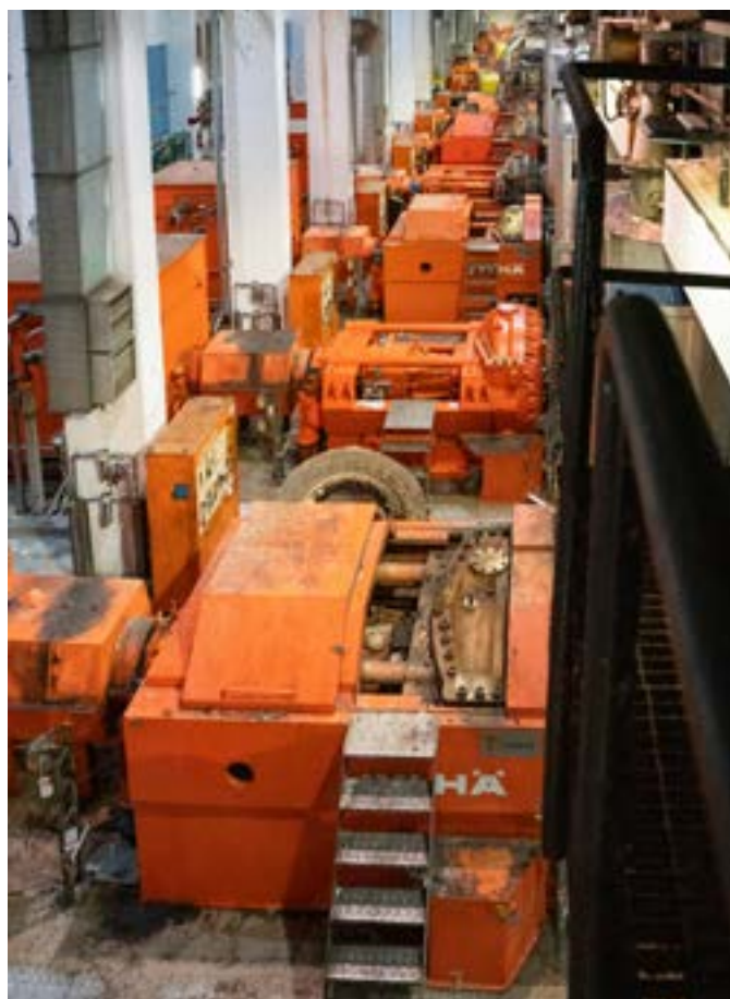
En lång rad av raffinörer som mal flis till pappersmassa. Det finns 18 stycken raffinörer varav två är betydligt större än de övriga.
