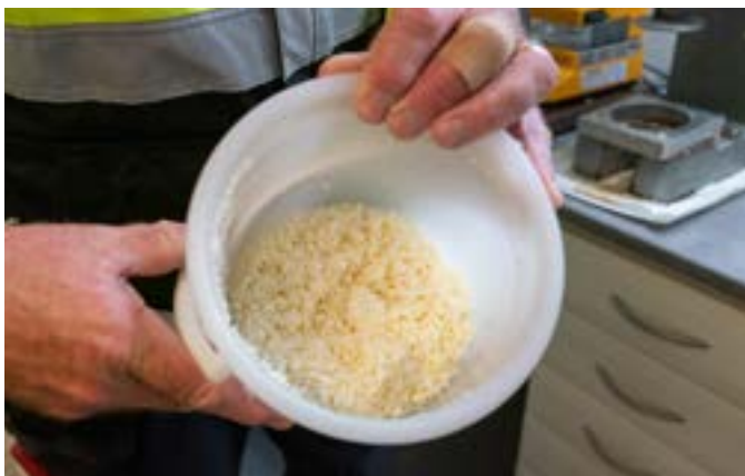
Massan från blekeriet innehåller 30% vatten.
