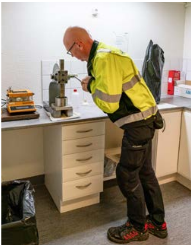
Massan pressas ur och vätskan blandas med kemikalier som ett delmoment i att bestämma rest-VP.
