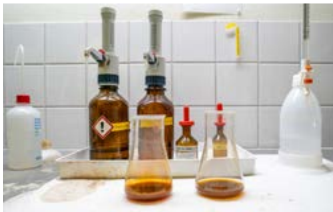
Efter inblandning av kemikalier ändras färgen på massavatt-net. Sedan mäts hur mycket av en annan kemikalie som behövs för att vattnet återigen ska bli färglöst. Detta mått är en parameter i uträkningen av rest-VP.
