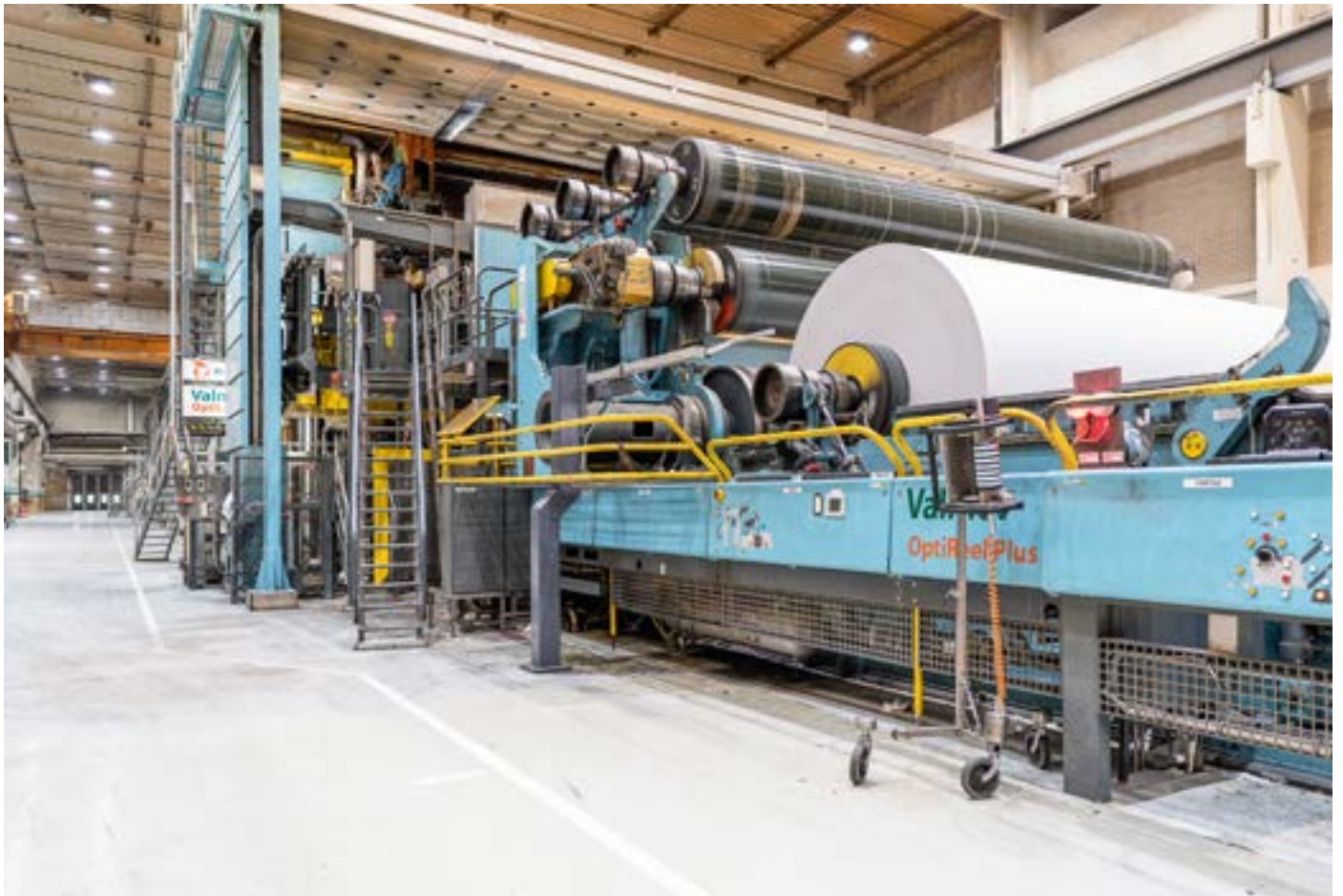
Från att massan sprutas in i inloppslådan till att det kommer ut färdigt papper på tambour tar det ca 15 sekunder.
