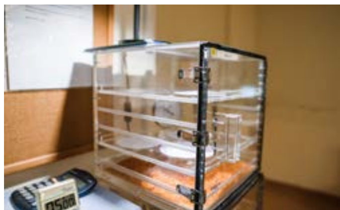
Det som först såg ut som en hamsterbur visade sig vara en mätstation för curl.
