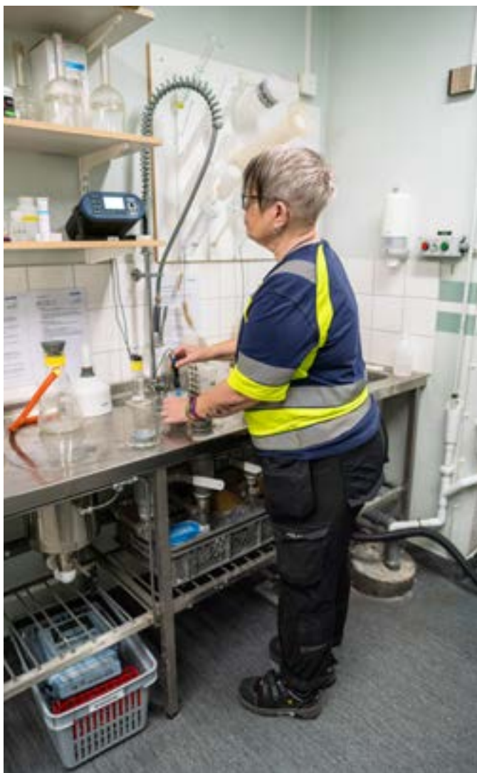
Jaana har varit ut till maskinen och tagit massaprov som hon nu mäter pH-värdet för.
